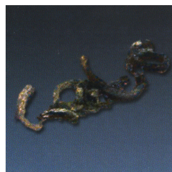
Stará grafitová či asbestová ucpávka po vyjmutí. Ucpávkové pouzdro musí být rozebráno a vyčištěno.
