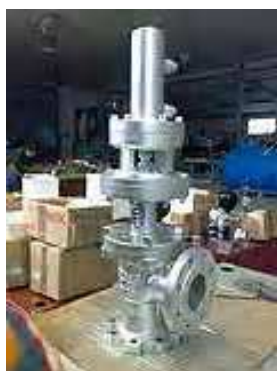
APD speciální výroba uzavíracích – regulačních ventilů ovládaných hydraulicky pro parní turbíny TG do 550°C
