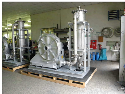
Výroba AIG, AIS, technologie pro odpařování čpavku
