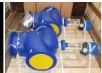
APD – rychlouzávěrné klapky na vstupním parovodu TG, vysokotlaká šoupátka s úpravou pro stojánek
