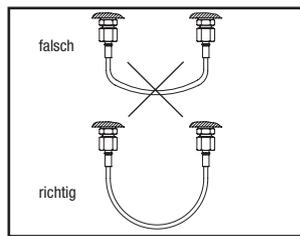
Bei gekrümmtem Einbau ist auf den zulässigen Biegeradius zu achten. Scharfe Knicke sind zu vermeiden. Bei der Längenberechnung einer gekrümmt verlegten Schlauchleitung ist zu beachten, dass die Anschlussarmaturen nicht flexibel sind. Die richtige Bemessung der freien Schlauchlänge zwischen den Armaturen ist daher wesentlich.
