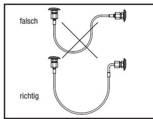
Für einen zweckmäßigen Einbau von Schlauchleitungen stehen Rohrkrümmer (90°-Armaturen) zur Verfügung. Der Radius dieser Verschraubungen ist so klein, dass auch bei beengten Einbauverhältnissen eine richtige Verlegung der Schlauchleitung gewährleistet ist.
