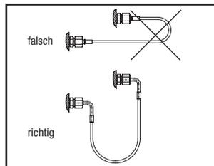
Rohrkrümmer (90°-Armaturen) sind dort angebracht, wo die Anordnung der Anschlüsse einen „hängenden“ Bogen nicht zulässt und bei „stehenden“ Bogen stets eine Knickgefahr hinter der Schlauchfassung besteht. Bitte die erforderlichen Halterungen (z. B. Schellen) in richtiger Größe verwenden. Der Schlauch darf weder in der Halterung reiben noch gequetscht werden. Die Halterung soll möglichst um den Schlauch herumgehen.
