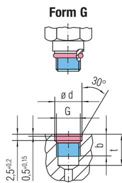
Einschraubloch nach HYDROTECHNIK Werknorm N 901-01-14 (Abdichtung durch O-Ring)
