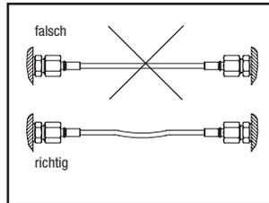
Unter Belastung kann sich eine Schlauchleitung in der Länge ändern. Eine Verkürzung bedeutet zusätzliche Zugbeanspruchung des Schlauches und der Anschlüsse. Im drucklosen Zustand muss die Schlauchleitung deshalb leicht durchhängen. Überwurfmuttern bitte nur so weit anziehen, bis der Anschluss dicht ist. Weiteres Anziehen verbessert die Dichtheit nicht, sondern beschädigt den Anschluss.
