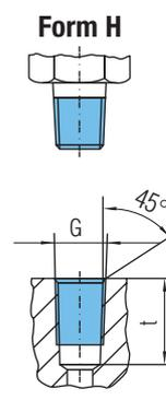
Einschraubloch nach ANSI/ASME B 1.20.1-1983 (selbstdichtendes Gewinde)
