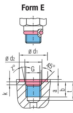
Einschraubloch nach SAE J 514 (UNF) oder nach ISO 6149-1 (Abdichtung durch O-Ring)
